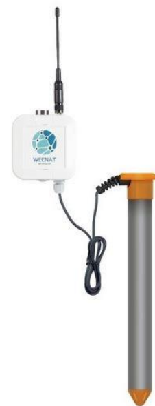
Sonde capacitive : mesure tous les 10 cm le long de la sonde
